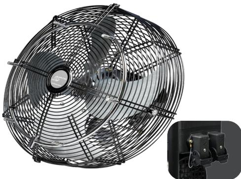
Una presa apposita permette di collegare la linea dei ventilatori alla centralina, la quale provvede ad attivare anticipatamente e interrompere con lieve ritardo la ventilazione rispetto alla nebulizzazione. Questa funzione mira ad evitare che la nebulizzazione non sospinta dal vento, possa precipitare anzitempo creando una mancanza di comfort e inumidendo la superficie immediatamente sottostante.
